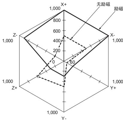
测量: 往3轴6个方向各加3次冲击, 测定接点产生误动作的值。但是, 励磁电压须在保持电压额定值范围内。
